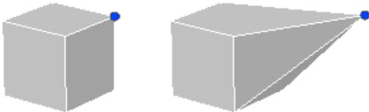
Vous pouvez également modifier la forme complète d'un solide 3D en modifiant un ou plusieurs sommets à l'aide des poignées et outils poignées disponibles, ou avec les commandes DEPLACER, ROTATION et ECHELLE. Lorsque vous mettez des sommets à l'échelle, vous devez également mettre à l'échelle au moins deux sommets pour voir un changement dans le solide.
