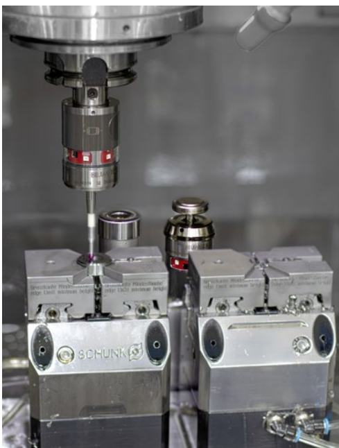
Der Messtaster TC52 und der Werkzeugtaster ZX-Speed IR werden mit nur einem einzigen Infrarotempfänger betrieben.
