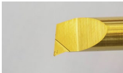
Bild links, Bild rechts, Aufmacherbild: Wirrspänekiller: Das Simturn AX-Werkzeug mit gelasertem Spanformgeometrie und innerer Kühlmittelzufuhr (nicht im Bild) ermöglicht zum Beispiel die präzise Bearbeitung tiefliegender Nuten in Ventildeckelgehäusen.
