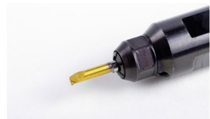
Bild links, Bild rechts, Aufmacherbild: Wirrspänekiller: Das Simturn AX-Werkzeug mit gelasertem Spanformgeometrie und innerer Kühlmittelzufuhr (nicht im Bild) ermöglicht zum Beispiel die präzise Bearbeitung tiefliegender Nuten in Ventildeckelgehäusen.
