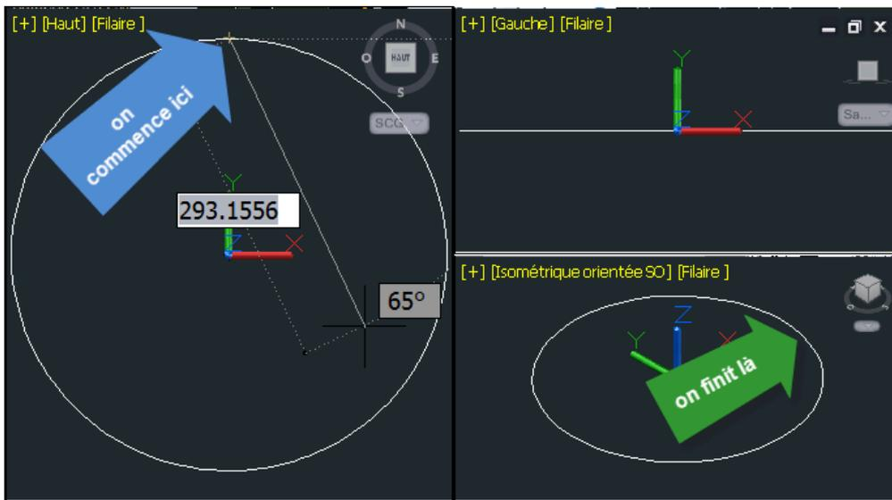
Vous voyez ici les deux intérêts d'avoir séparé la zone de dessin en plusieurs fenêtres: on voit les objets sous différents points de vue et on travaille ces objets en utilisant le point de vue le plus adapté à la tâche en cours.
